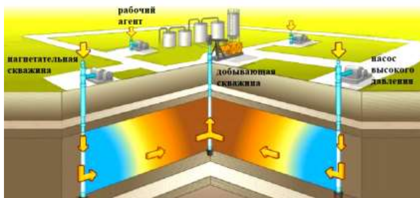
Рисунок 2. Схема вытеснения энергоресурса растворами поверхностно-активных веществ (ПАВ)
